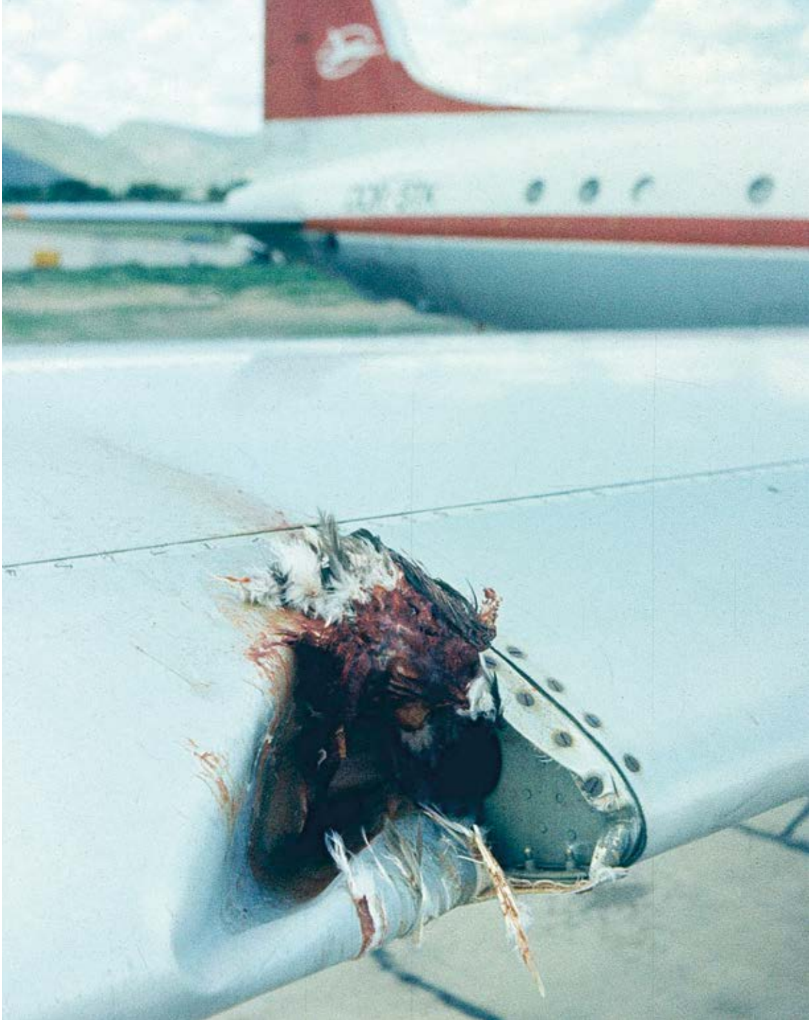
Abb. 69: Vogelschlag an einer Iljuschin Il-18 der Interflug (1985) / Foto: Privatbesitz (ehemaliger Angehöriger der Interflug).
